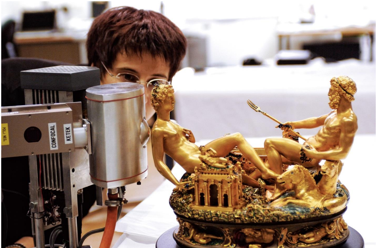
Copyright © Dean Calma, IAEA - Detailansicht des Messkopfs des RFA-Geräts, PART I der IAEA bei der Analyse der Saliera
